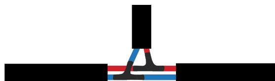
Isole toda a emenda com fita de autofusão, iniciando e terminando pelas capas, deixando uma extremidade de pelo menos 5 cm.
