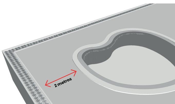
Não instalar dentro ou próximo a reservatórios de água, como piscinas, fontes, entre outros. Respeite a distância mínima de 2 metros, de acordo com a **NBR 5410**. É necessário impedir a concentração de água ao redor do produto e das emendas.
